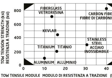
La fibra di carbonio serve a formare materiali detti "compositi", in quanto le fibre sono poste su una matrice (ex: una resina epossidica) che mantiene e protegge la corretta orientazione delle fibre, in modo tale che il prodotto assorba gli urti e mantenga la forma originaria. Tra le sue caratteristiche spiccano la resistenza meccanica, la bassa densità, la capacità di isolamento termico e la resistenza a variazioni di temperatura e all'effetto di agenti chimici.
